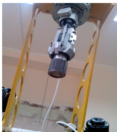
Рис. 3. Захват автоматический универсальный в процессе операции с цилиндрическим объектом
